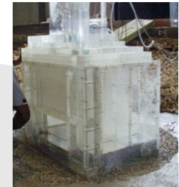
Modelo físico da adaptação de uma central de energia das ondas ao molhe Norte do Douro
