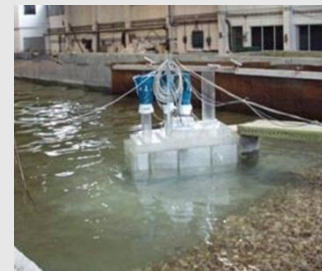
Modelo físico da adaptação de uma central de energia das ondas ao molhe Norte do Douro
