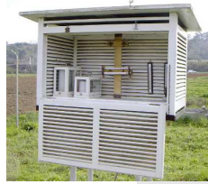
Estação (temperatura, humidade, barometria, pressão, ...)
