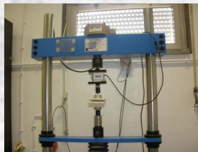
Fig. 5 - Esquema de montagem do ensaio de aderência na máquina de esforços universal
