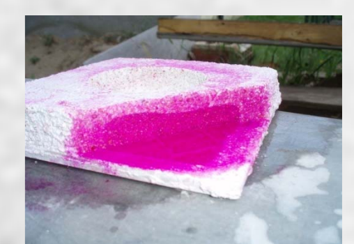
Fig. 11 - Profundidade de carbonatação
