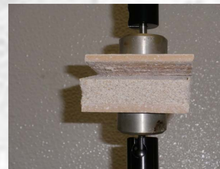
Fig. 6 - Esquema de montagem do ensaio de aderência na máquina de esforços universal
