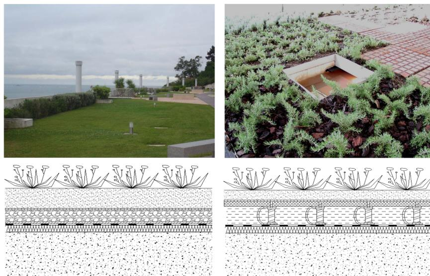
Fig. 2 - Coberturas vegetalizadas, sem ou com retenção de água
