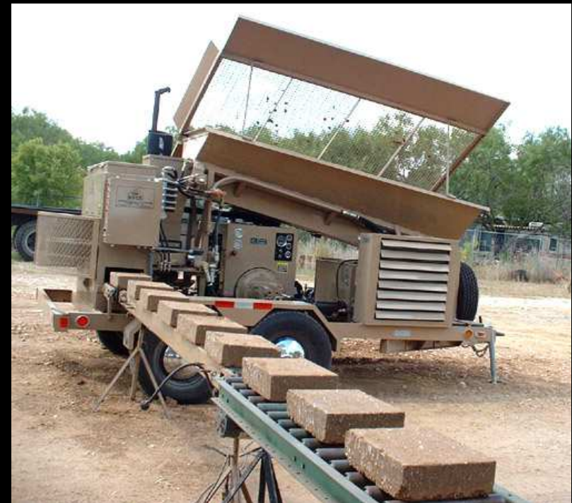
máquinas de BTC
