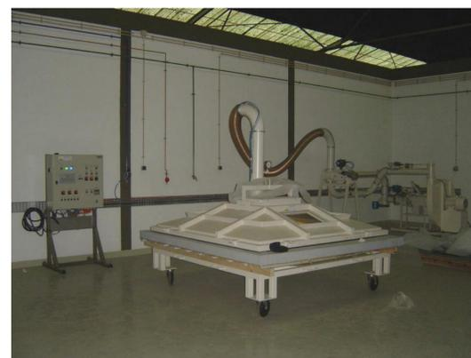
Fig. 1 - Equipamento para ensaio de sucção do vento do LNEC
