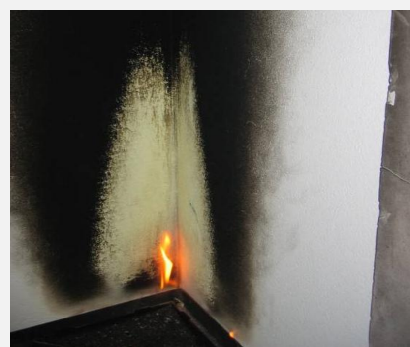
Figura 2 – Ensaio de reação ao fogo
