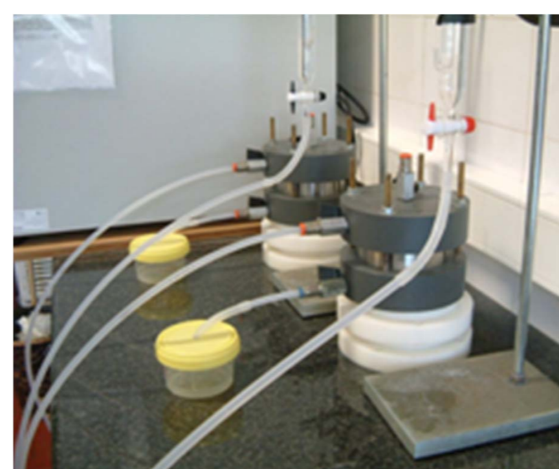
Figura 1. Ensaio de permeabilidade com as lamas em permeâmetro de paredes rígidas
