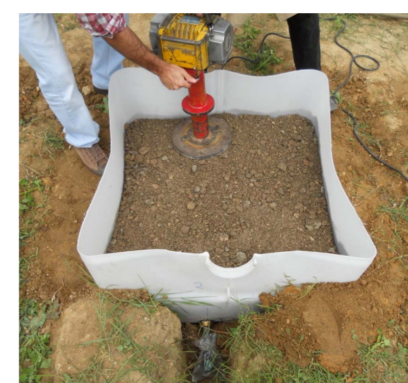
Figura 6. Construção de lisímetro para avaliação da perigosidade ambiental de RCD
