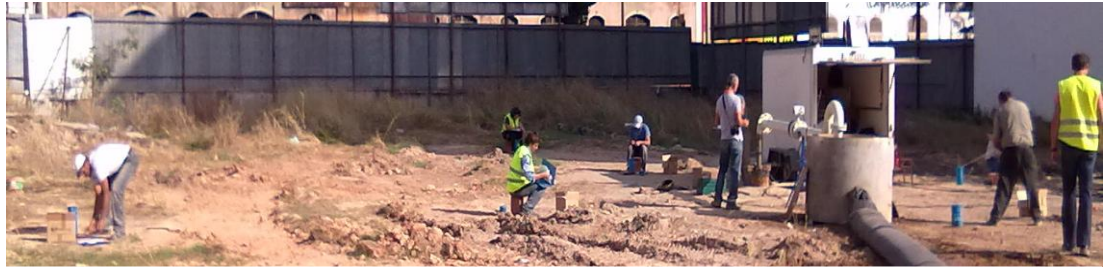
Ensaio de bombagem para determinação de parâmetros hidráulicos (Alcântara). REFER
