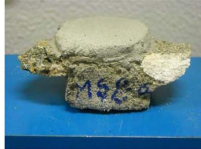
Figura 12: Amostra antiga com argamassa de confinamento para o ensaio de compressão
