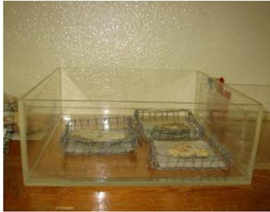
Figura 11: Ensaio de absorção capilar por contacto
