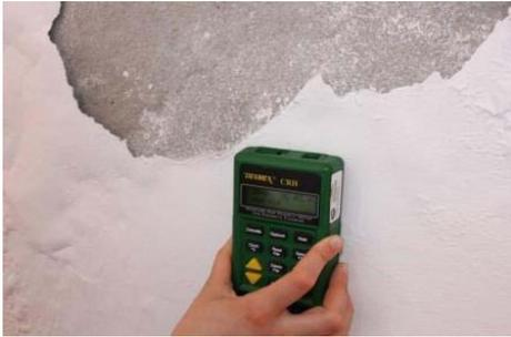
Figura 3: Ensaio com Humidímetro
