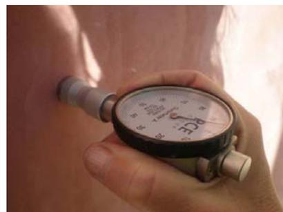
Figura 6: Ensaio com o Durómetro
