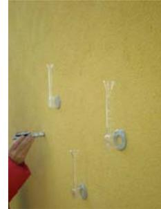
Figura 4: Ensaio com os Tubos de Karsten
