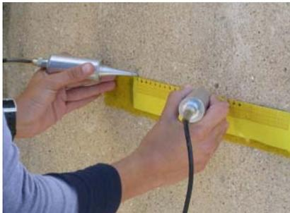
Figura 5: Ensaio com Ultrassons
