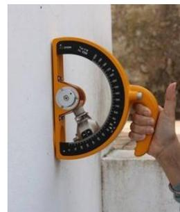
Figura 8: Ensaio com o Esclerómetro
