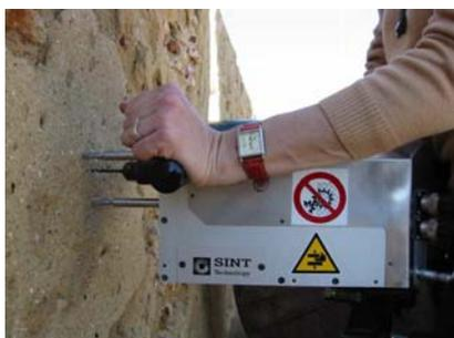
Figura 9: Ensaio de penetração controlada
