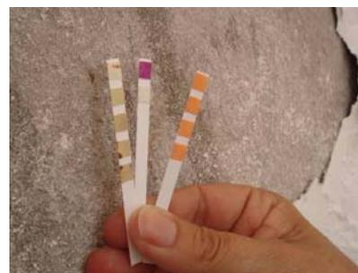
Figura 10: Identificação de sais através dos marcadores colorímetros
