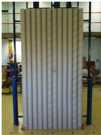
Figura 1 – Corpo-de-prova preparado para o ensaio de resistência a impactos de corpo duro.
