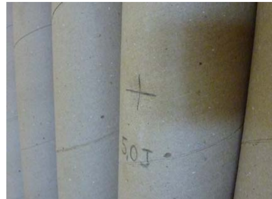
Figuras 7 a 10 – Mossas ocasionadas nos painéis após os impactos de corpo duro.
