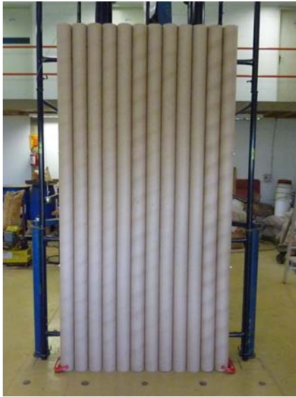
Figuras 5 e 6 – Corpo-de-prova após os impactos de corpo duro.
