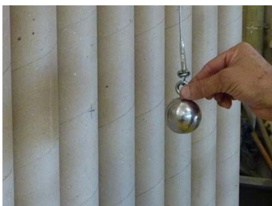
Figuras 3 e 4 – Realização do ensaio de impacto de corpo duro.
