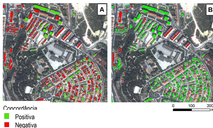
Figura 5 - Resultados de concordância entre objectos extraídos por um método semi-automático e as especificações nacionais da cartografia 1.5 000 (A) e 1:10 000 (B)
