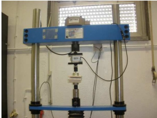
Figura 1 – Esquema de montagem do ensaio de aderência na máquina de esforços universal
