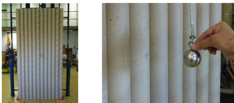
Figuras 3 e 4: Ensaio de impacto de corpo duro em painéis criados no Brasil.
