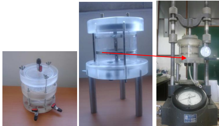
Figura 1: a) Interface de pressão água/calda; b) molde de injeção (com visualização do injector no seu interior), c) Fase de injeção do provete arenoso com aplicação de tensão de confinamento vertical no topo do molde
