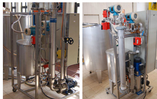
Figura 2. Pilotos de PAC/MF (1,5 m 3 /h) e NF (4,5 m 3 /h)
